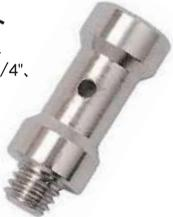
片方がオスの細ネジでもう一方がメスの太ネジになっています。そのままオスうけダボや先端がメスになっているスタンドなどに取付けるとオスカメスのネジ部分のみが出るようになります。また、別売のスピゴット[S-4M8M]、スピゴット[S-4M8F]、スピゴット[S-4F8F]などと組み合わせ使用することもできます。
