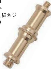
オスうけダボに取付けたり、先端がメスになっているスタンドなどに使用して16mm のオスダボに変換するスピゴットです。先端のネジ部分は片方が細ネジでもう一方が太ネジになっています。用途によって使い分けてください。
